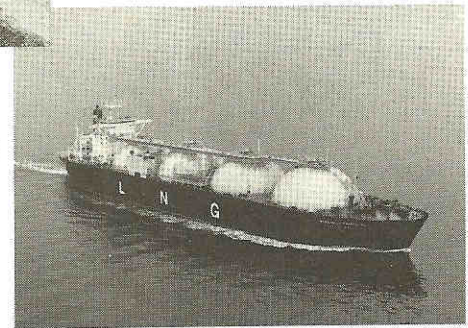
LNG Ariès is a 125,000 m 3 LNG tanker with four cargo spheres
